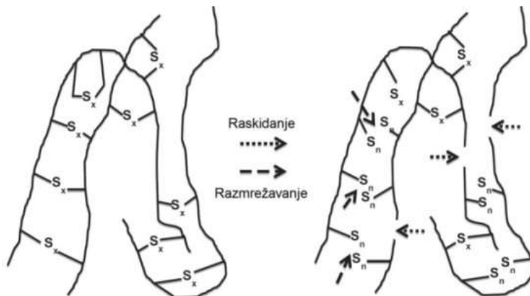
Slika 2. Prikaz strukturalnih izmena u postupcima recikliranja elastomera umreženih sumporom.
