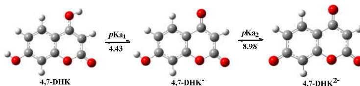
Slika 2: Proces deprotonacije i optimizovane strukture acido-baznih vrsta 4,7-DHK na M062X/6-311++G(d,p) nivou teorije
